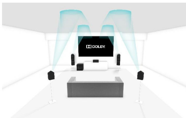
Configuración de altavoces en el hogar con sonido reflejado en techo. Fuente: Dolby
