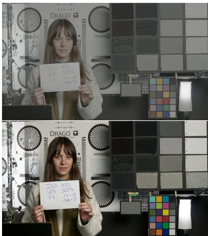
Uso de una Lut para pasar del espacio de color [Arri LogC] a [Rec.709].
